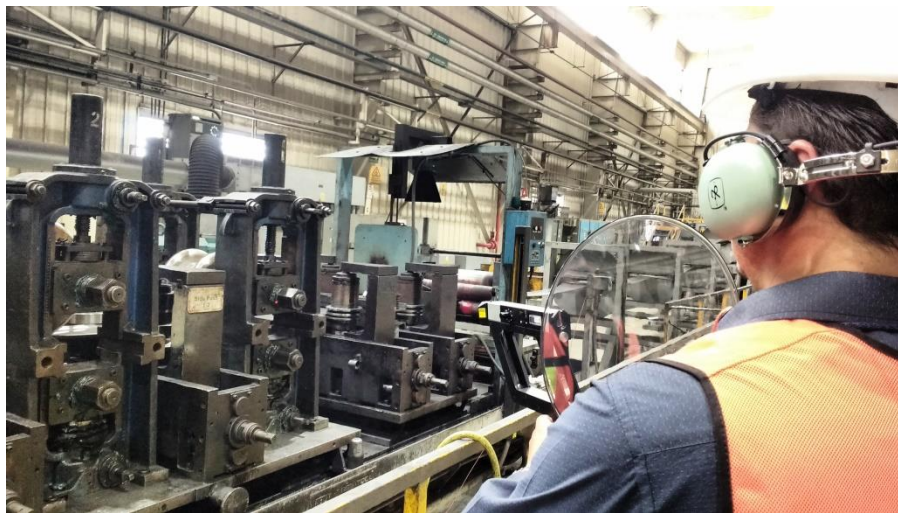
FIGURA 7: EL UL101 EN CONJUNTO CON EL POWER BEAM 300 SON CAPACES DE RECOLECTAR INFORMACION CON UNA PRESICION DE 1° A 90 METROS DE DISTANCIA LO QUE ABRE UN MUNDO DE POSIBILIDADES DE INSPECCION
