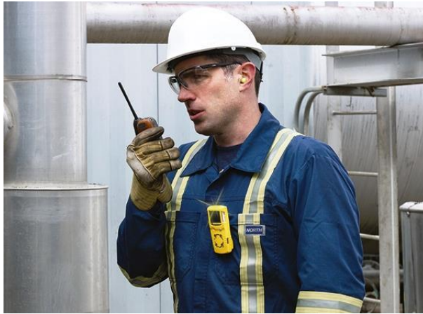
FIGURA 3: LOS DETECTORES PORTATILES DE GASES PROTEGEN A LOS USUARIOS MEDIANTE AVISAR OPORTUNAMENTE LA PRESENCIA DE DETERMINADO GAS O UN NIVEL BAJO DE OXIGENO, SIN EMBARGO NO SON CAPACES DE UBICAR EL SITIO EXACTO DE LA FUENTE DEL PROBLEMA
