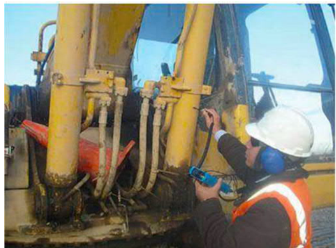
Fig. 8.35 Inspector de Ultrasonido haciendo pruebas en Equipo Hidráulico
