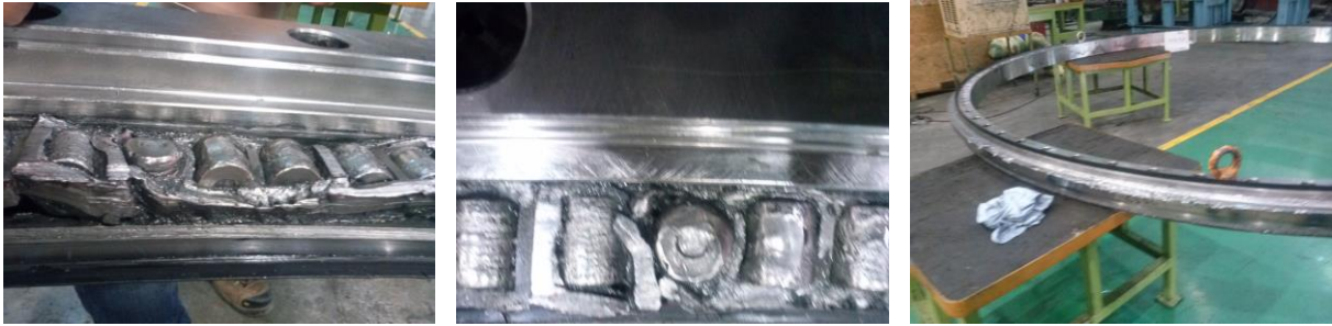
Fig. 1.11 Detección con Ultrasonido Propagado en Aire/Estructuras del Índice de Fricción del rodamiento y fotografías de cuando fue removido de operación
