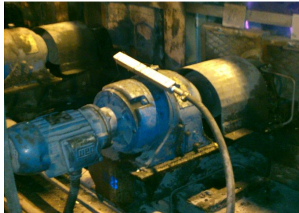
Fig. 1.9 Para minimizar el problema, Ternium México implementó el uso de boquillas especiales, cada una de ellas en estas condiciones operativas ahorra hasta 370 CFM
