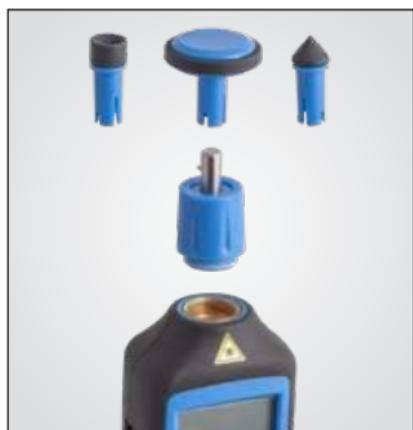
Он поставляется с тремя контактными переходниками для измерения угловой и окружной скорости контактным способом.
