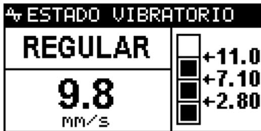
Todo lo que se requiere para conocer el estado vibratorio es ingresar la potencia de la máquina, el tipo de base rígida o flexible para que Vibracheck indique si el nivel de vibraciones es aceptable, regular o inaceptable.
