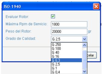
Por ejemplo, para Ventiladores y Bombas, la norma ISO 1940 define un grado de calidad G6,3. Para máquinas herramientas y rotores de turbogeneradores rígidos, define un grado de calidad G.25.
