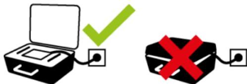
Tanto la unidad de pantalla como las unidades de medición (M6 y S6) se pueden conectar a un cargador para efectuar la carga mientras se encuentra en la caja. Es importante que la tapa de la caja esté abierta durante la carga o el sistema no se cargará correctamente y podría resultar dañado.
