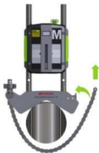
Apretar firmemente la cadena con el tornillo tensor. Si es necesario, utilizar la herramienta tensora suministrada. No tensar en exceso. Si el diámetro del eje es demasiado grande, las cadenas podrán extenderse con las cadenas de extensión.
