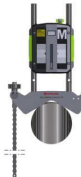
Levantar el extremo abierto de la cadena, tensarla de manera que desaparezca el aflojamiento y fijarla al gancho.
