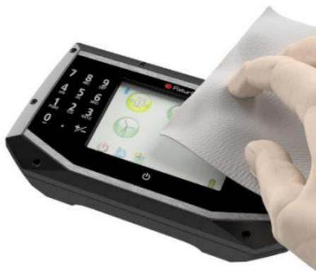
Para que funcione de la mejor manera posible, las aperturas de los diodos, las superficies del detector y los bornes de conexión han de mantenerse libres de suciedad o grasa. La unidad de pantalla ha de mantenerse limpia y la superficie de la pantalla protegida contra rayaduras.
