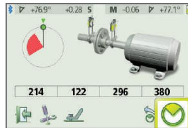
Gire los sensores a la segunda posición. Pulse de nuevo el icono de medición para efectuar la segunda medición.
