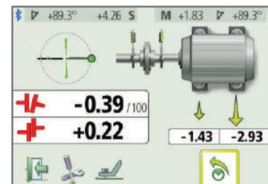
... para realizar la corrección horizontal con valores en tiempo real. Verifique sus correcciones volviendo a realizar las mediciones.
