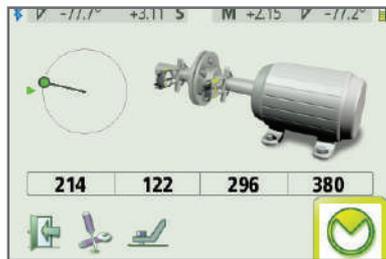
Gire los sensores a la primera posición y pulse el icono de medición.
